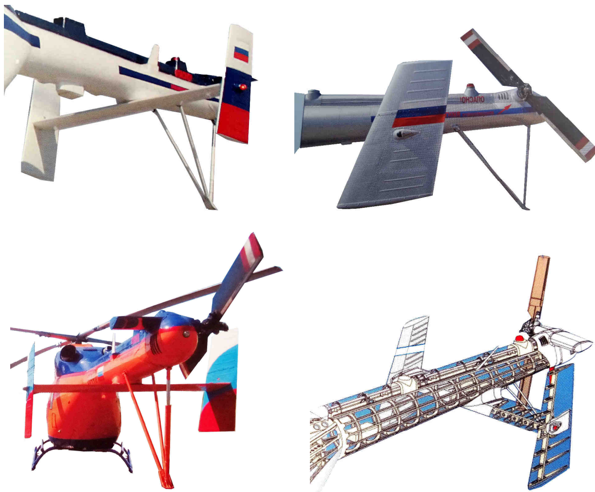
Рис. 12. Конструкция хвостовой балки вертолета Ансат
