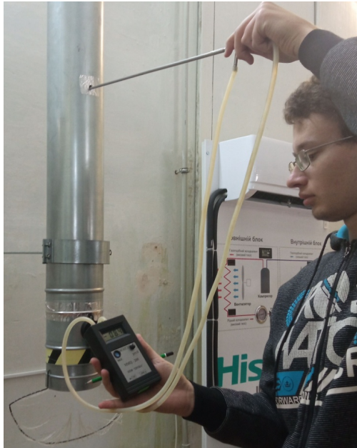
Рис. 7. Визначення динамічного тиску мікроманометром ММЦ-200
