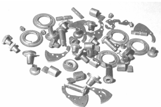
Рис.11. Примеры деталей, обрабатываемых на установке ГСЦУ-10
