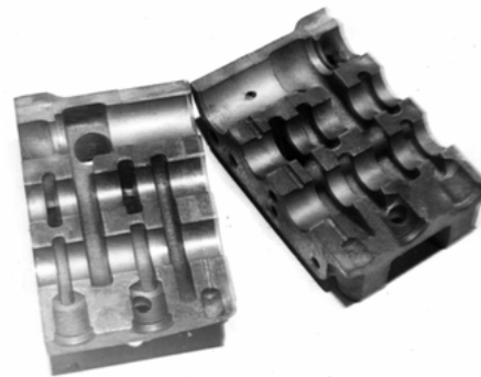
Рис. 15. Полости разрезанного корпуса гидрораспределителя после обработки на установке ГАУ-600
