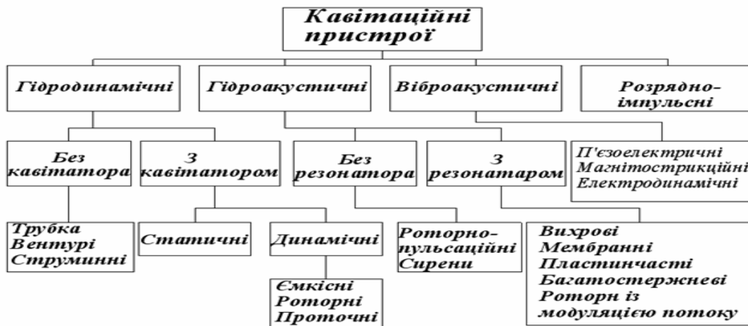
Рис. 1. Основні різновиди структурно-конструктивних схем кавітаційних пристроїв
