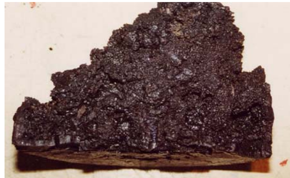
Рис. 5. Пористий матеріал \text{CaO} + \text{WO}_3 , отриманий при охолодженні водою.
