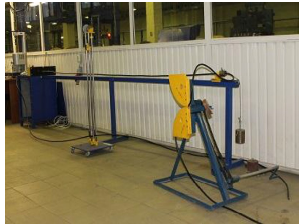
Рисунок 6 – Установка для випробування на стійкість до осьового кручення
