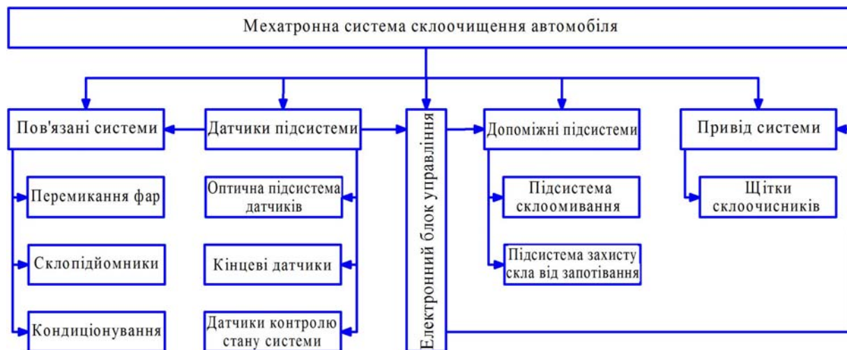
Рисунок 1 – Зв'язок системи склоочиснення з підсистемами забезпечення комфорту і безпеки автомобіля
