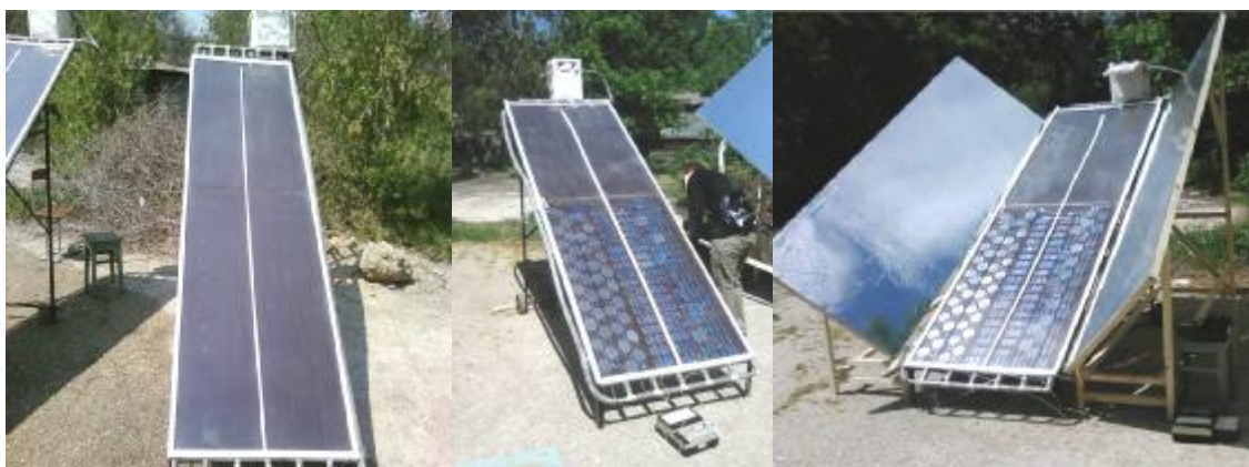
Рис. 2. Тепловой гелиопрофиль (слева), теплофотоэлектрический гелиопрофиль (по центру), теплофотоэлектрический гелиопрофиль с концентратором (справа)
