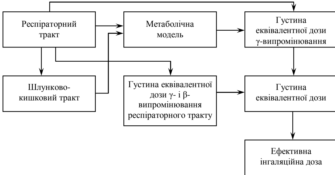
Рис. 2. Блок-схема розрахунку доз внутрішнього опромінення людини за рахунок інгаляційного надходження радіонуклідів в організм
