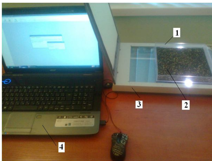
Рис. 1. Побудова фото перерізу отриманої суміші: 1 – прозоре деко; 2 – вихідна суміш; 3 – сканер; 4 – комп'ютер
