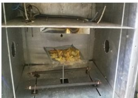
Рис. 1. Внутрішній вигляд радіаційно-конвективної сушильної установки
