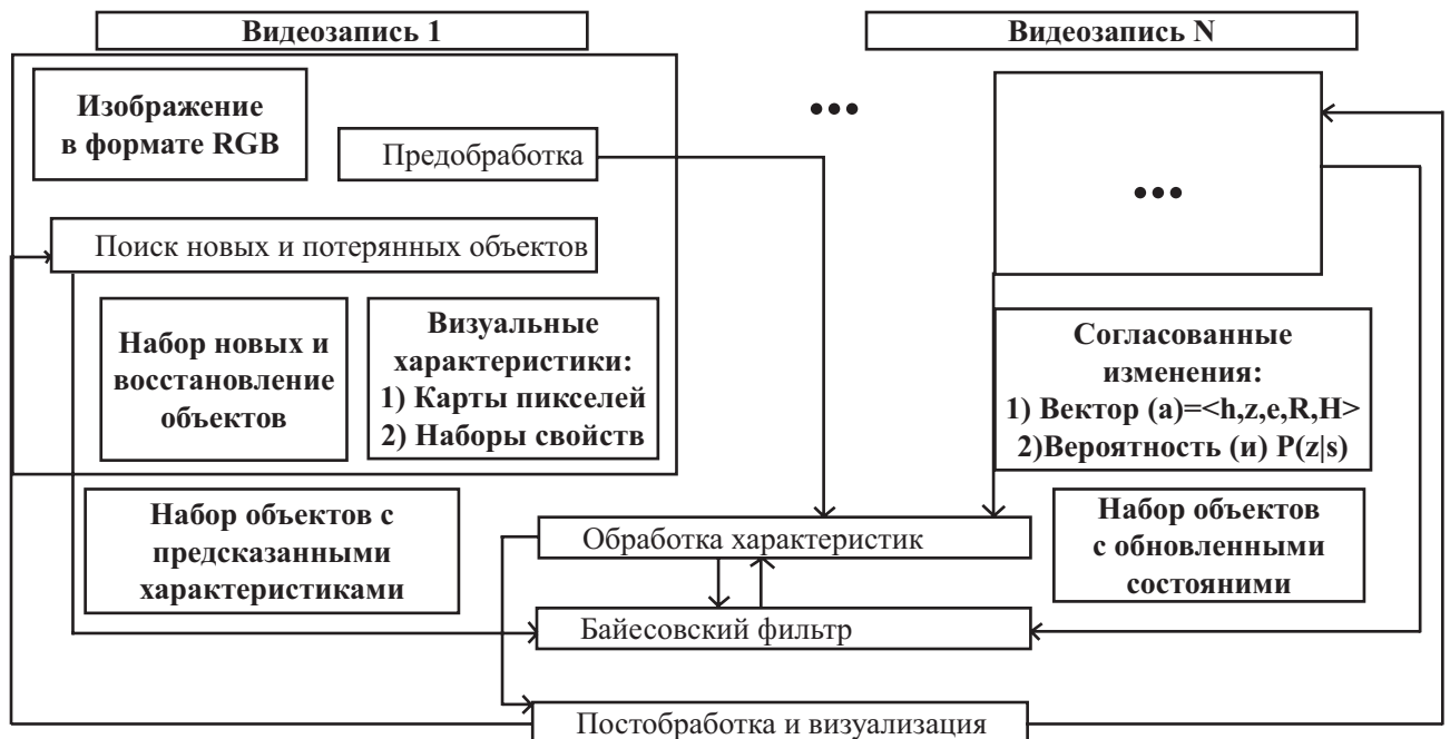
Рис. 8. Конвейер распознавания и отслеживания объектов в видеозаписях [19].
