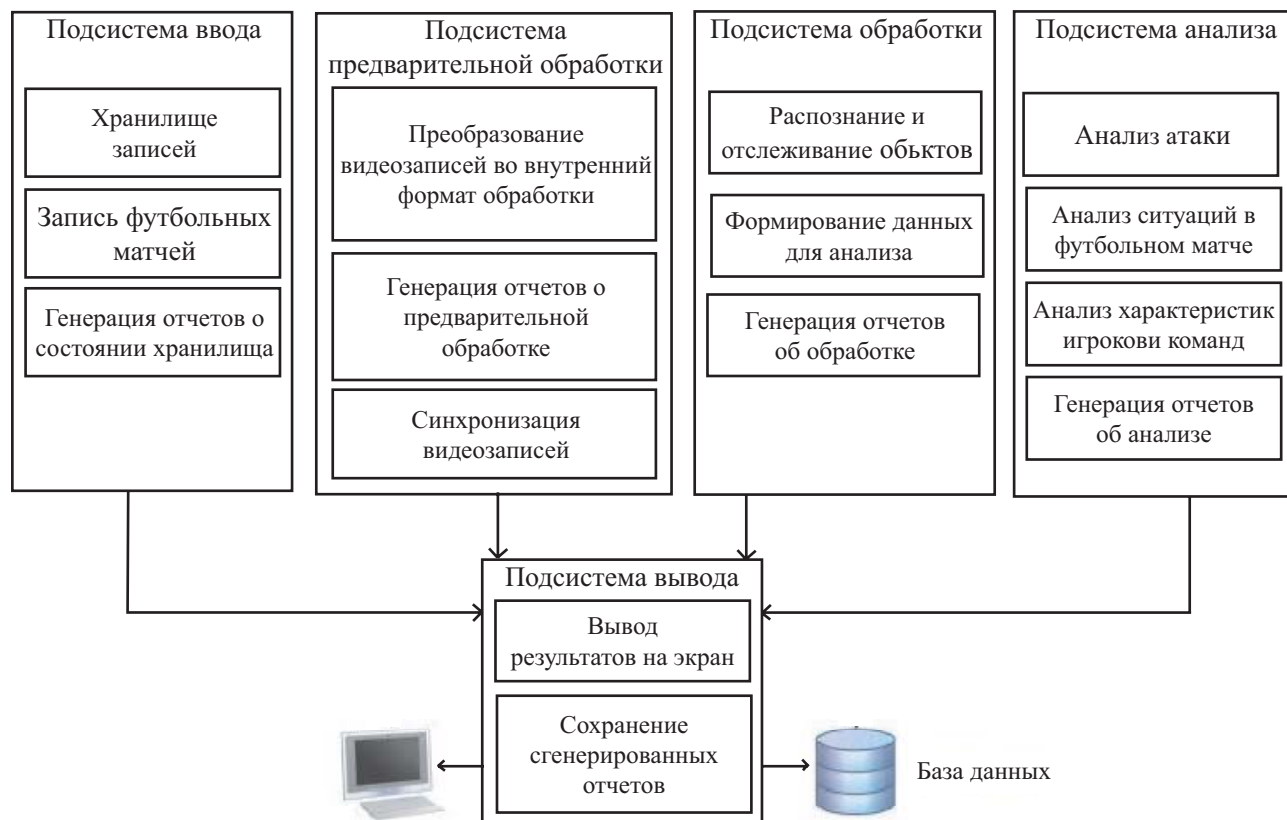
Рис. 3. Общая архитектура программного комплекса анализа видеозаписей спортивных игр [6].
