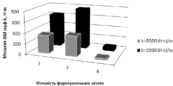
Рис. 25. Гістограми зміни відхилення динамічної складової пружного моменту у муфті на кожний формувальний візок залежно від кількості візків в установці (від виду приводу)
