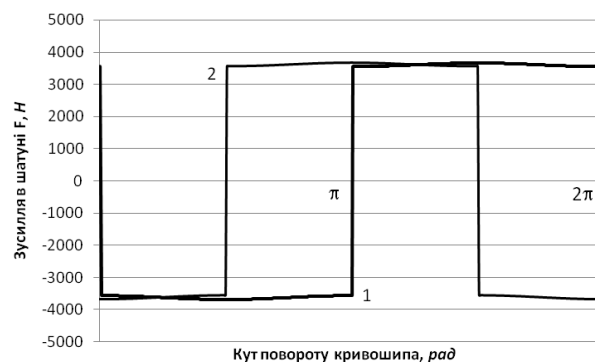
Рис. 8. Графік зміни зусилля в шатунах F_1 (1) та F_2 (2) залежно від кута повороту кривошипа
