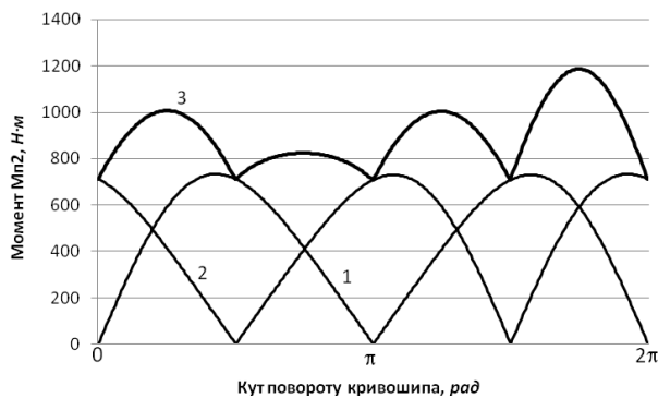
Рис. 9. Графік зміни моментів сил опору M_{o1} (1), M_{o2} (2) та M_{n2} (3) залежно від кута повороту кривошипа
