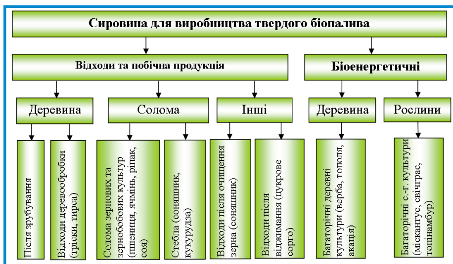
Рис. 1. Класифікація сировини для виробництва твердо-го біопалива.
