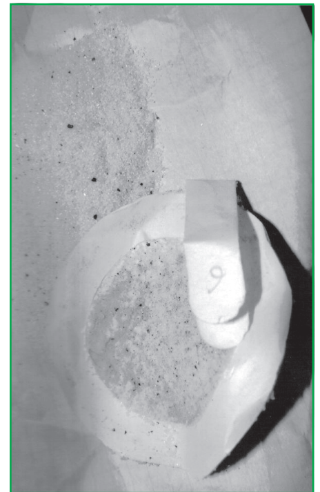
Рис. 2. Фільтр, наповнений цукром при виробництві цукру
