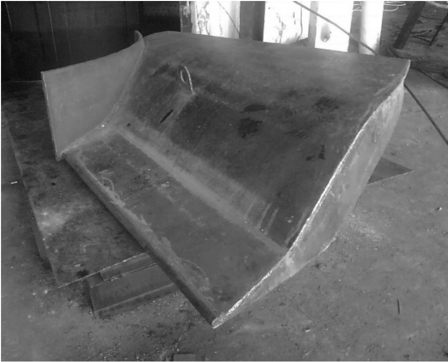
Рис. 3. Монтаж лопатей хвилеподібної форми на колонному дифузійному апараті КД2-А30 Миронівського цукрового заводу
