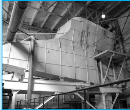
Унікальна сушарка для сушіння цукру у псевдо зрідженому шарі (Яготинський цукровий завод)
