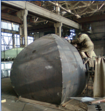
Виготовлення робітниками фільтра МВЖ
