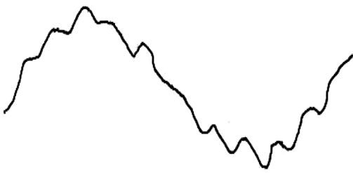
Рис. 1. Характер впливу тиристорних перетворювачів на синусоїду напруги живлення
