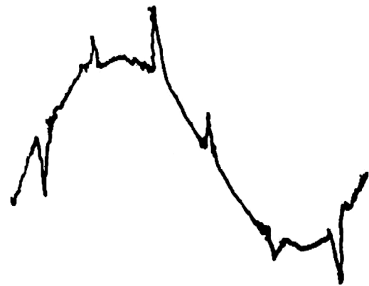
Рис. 2. Характер впливу частотних перетворювачів на синусоїду напруги живлення
