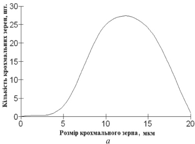
Рис. 5. Гранулометричний аналіз амілопектинового (а) і високоамілозного (б) видів кукурудзяного крохмалю
