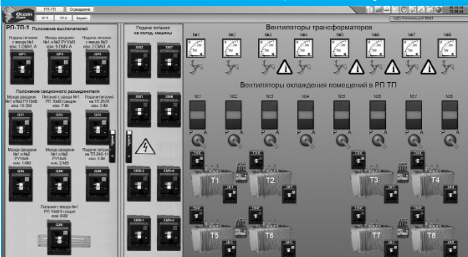
Рис. 6. Мнемосхема системы распределительной подстанции
