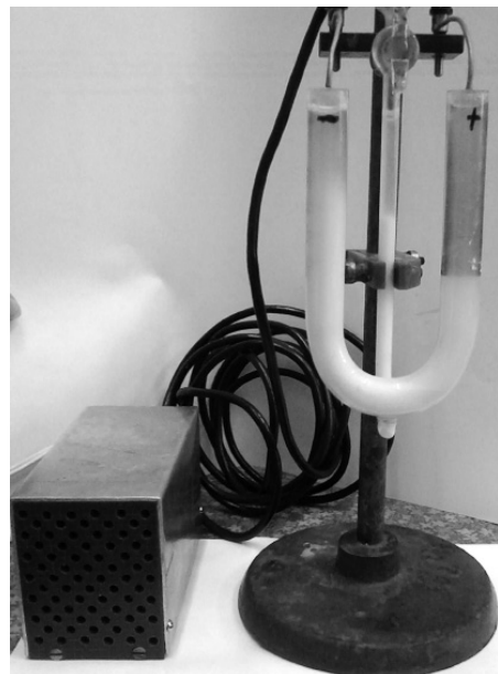
Рис. 1. Електрофорез суспензії Са(ОН) 2
