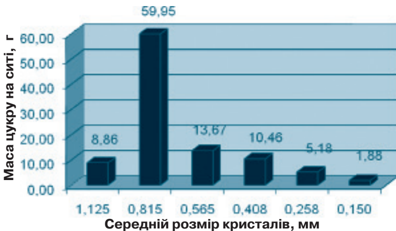
Рис. 2. Результати гранулометричного аналізу проби №1 (цукор після сушильної установки)
