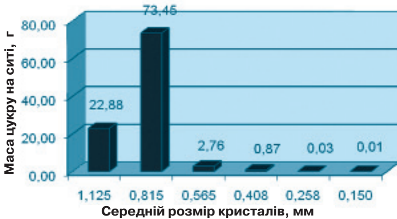
Рис. 1. Результати гранулометричного аналізу проби №1 (цукор після центрифуг)
