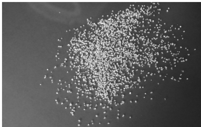
Фото. 3. Кристали затравки в пасти фірми «Магмас» ( \ell = 10 \dots 20 мкм)
