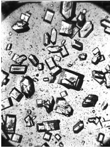
Фото 2. Кристали цукру, отримані при періодичній підкачці сиропу в апарат в умовах метастабільної зони перенасичення впливають на нерівномірність кристалів у готтовому утфелі.
