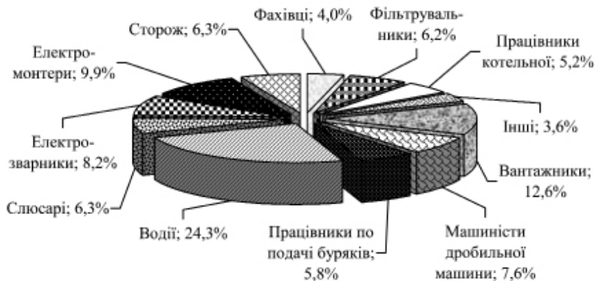
Рис. 1. Розподіл смертельно травмованих працівників на підприємствах та в організаціях цукрової промисловості за групами професій у 1998...2013 рр.
