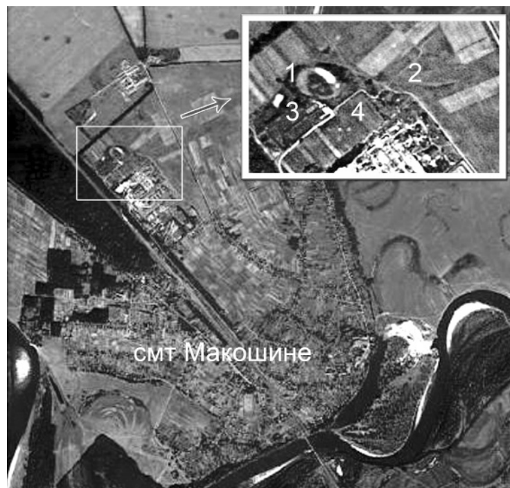
Рис. 1. Місце розташування цукрового заводу у смт Макошине Менського р-ну Чернігівської обл. 1 – висухла ложе заводського ставка; 2 – мікрозападина на місці виробничих споруд (вигін); 3 – сучасні комунальні очисні споруди; 4 – споруди цегляного заводу, згодом заводу ЗБК («3» і «4» – в межах проммайданчика колишньої макошинської цукроварні).
