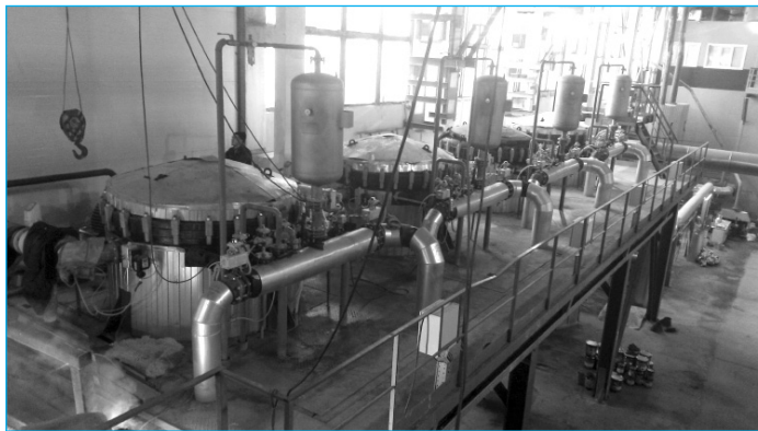
Станція фільтрації соку II сатурації, Слеський цукровий завод
