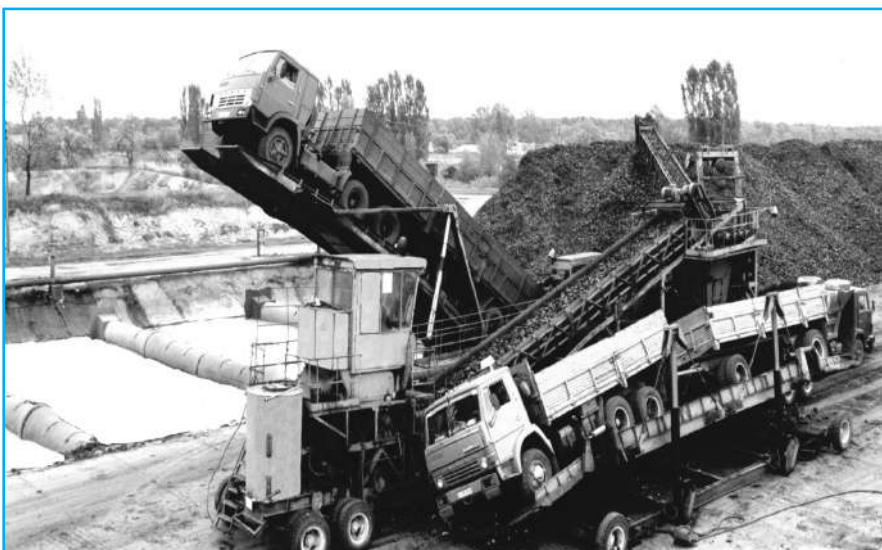
Буртоукладчик фронтальний Ш1-ПКФ (розробка УкрНДІЦП)
