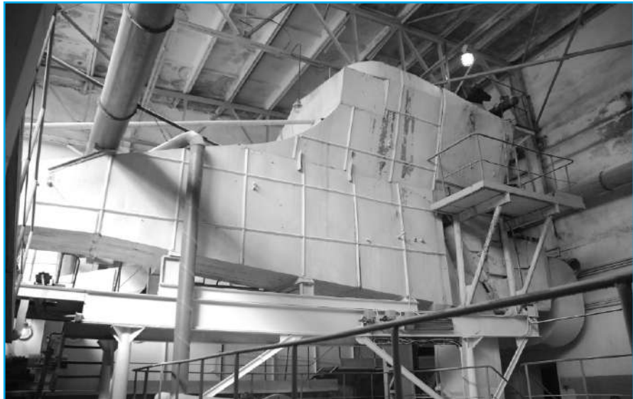
Унікальна сушарка для сушіння цукру у псевдозрідженому шарі (Яготинський цукровий завод)
