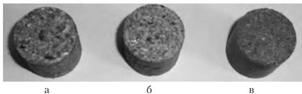
Рис.3. Зразки пелет (діаметр 27 мм, довжина 30 мм) з соломи (а), суміші тирси та соломи (б), соломи, тирси та листя дубу (в), виготовлених при тиску 263,2 МПа.
