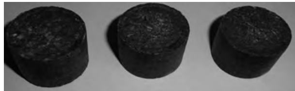
Рис.5. Зразки пелет діаметром 27 мм, виготовлених з соломи та ПЕТ, вміст якого складає, %: а – 10; б – 20; в – 30.
