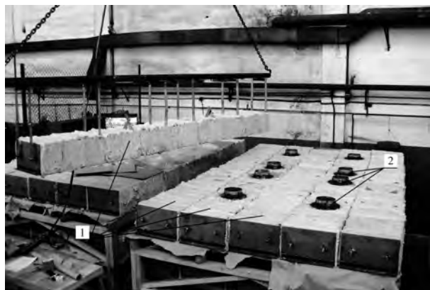
Рис.2. Общий вид плит теплоизоляционного свода с гильзами (подготовленные к отправке): 1 — плиты из муллитокремнеземистого волокна; 2 — гильзы из жаростойкой высоколегированной стали для установки сводовых горелок.
