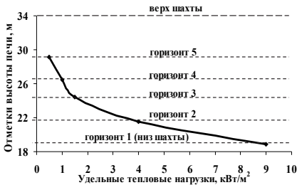
Рис.4. Удельные тепловые нагрузки по высоте шахты
