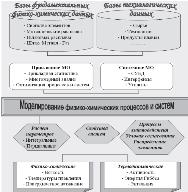
Рис.1. Структурная схема информационно-аналитической системы «РАСПЛАВ»
