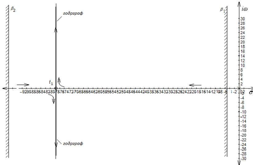
Рисунок 3 – Корневой годорограф Теодорчика – Эванса полинома (11.2) расширения при значении  $a_1 = 155$
