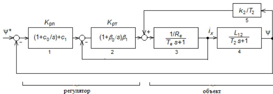
Рисунок 1 – Структурная схема системы управления электропривода
