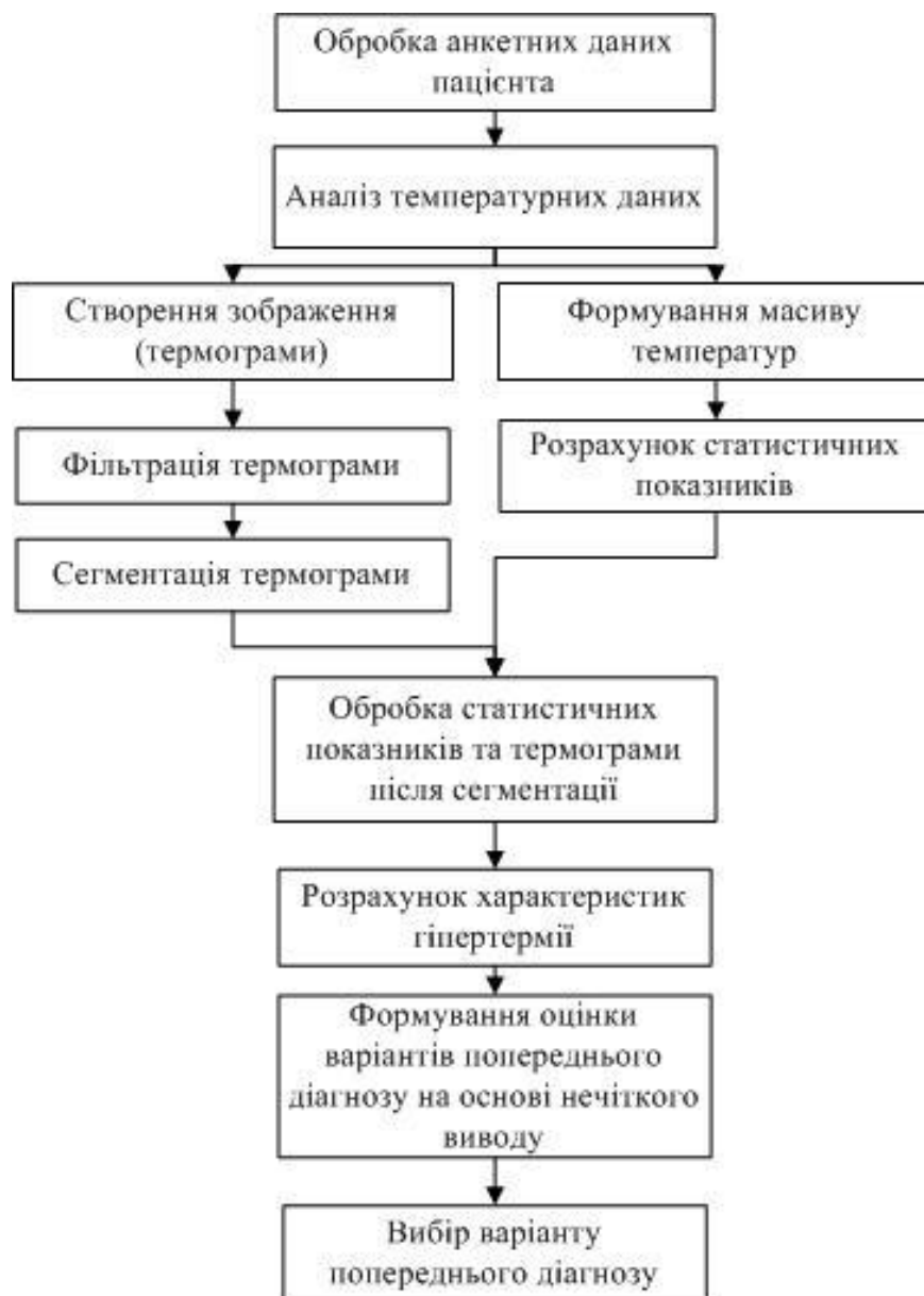
Рис. 4. Узагальнений алгоритм функціонування інформаційної технології діагностики
