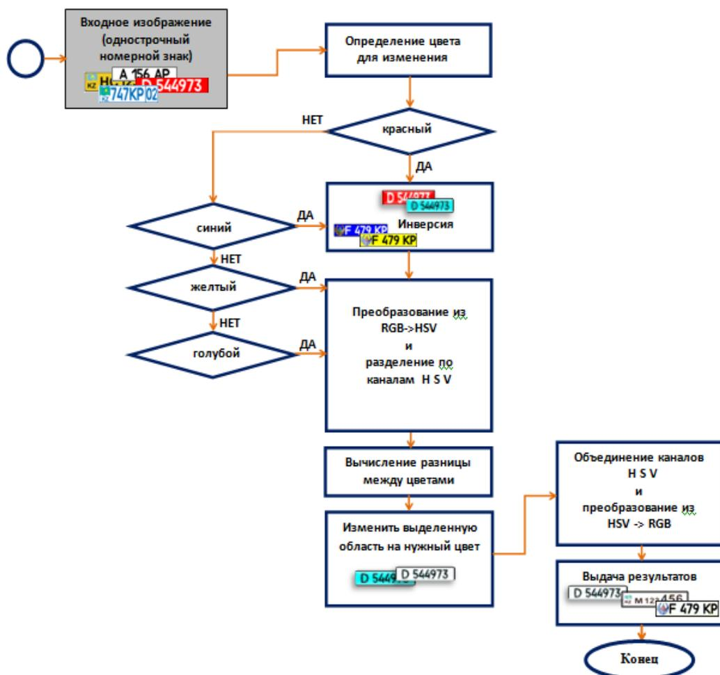
Рис. 6. Схема алгоритма преобразования цветов фона и буквенно-цифровых символов для получения изображений в однородной палитре серого цвета
