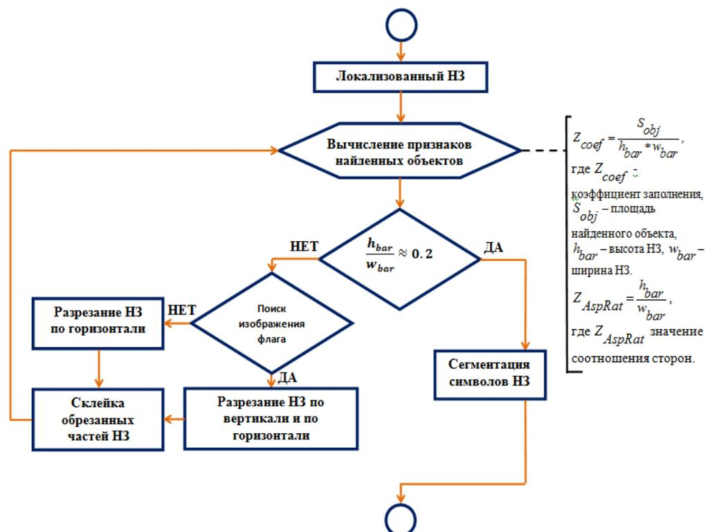
Рис. 5. Алгоритм преобразования двустрочных номерных знаков к однострочным
