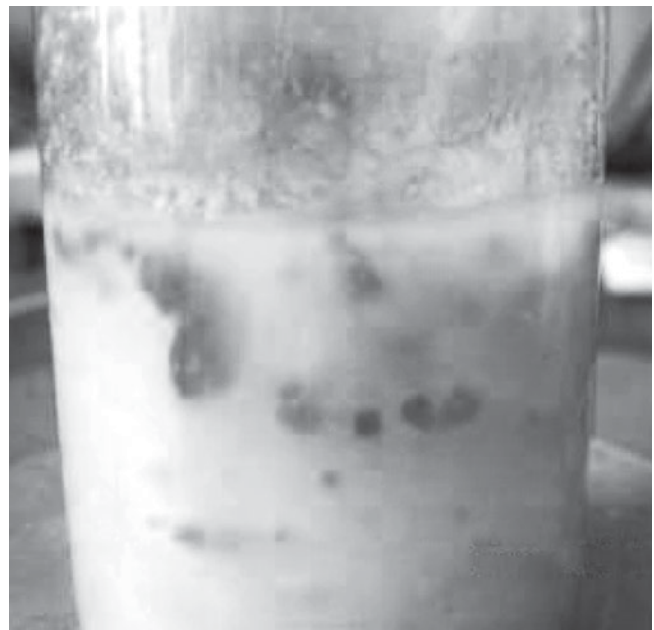
Рис. 3. Суміш «вода–нанокремнезем–олія льону» до (а) і після (б) перемішування ( \omega=1500 об./хв; \tau=10 хв)
