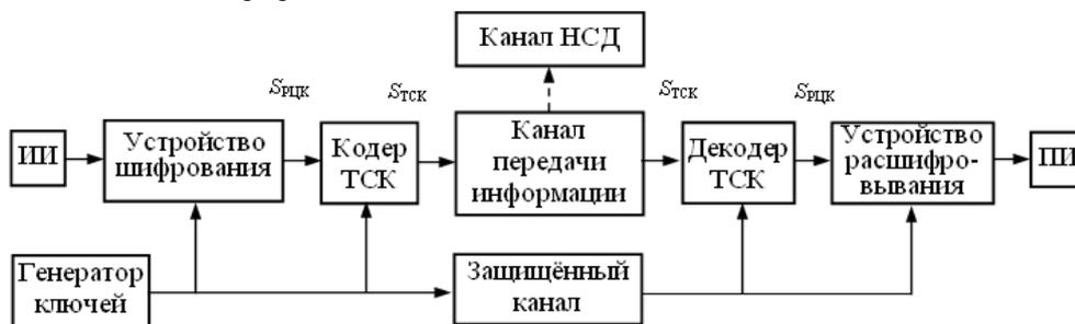
Рисунок 2 – Упрощенная структурная схема системы передачи конфиденциальной информации
