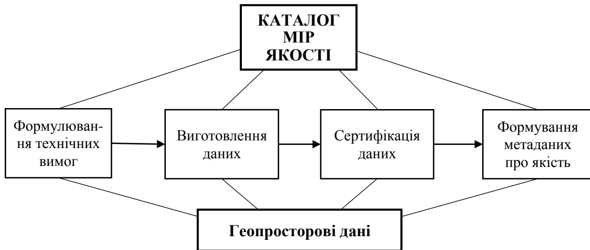
Рис. 1. Схема використання електронного каталогу мір якості даних
