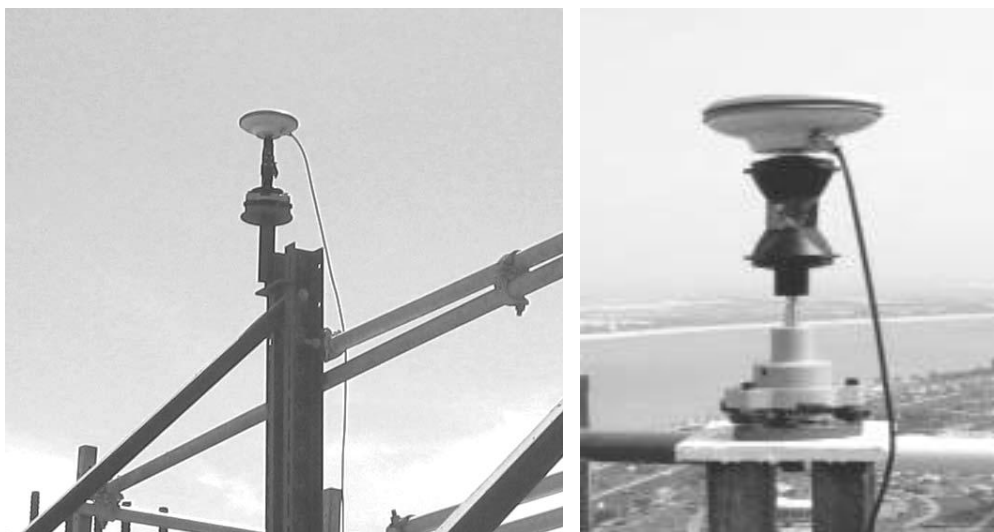
Рис. 4. Приймачі на монтажному горизонті з призмами 360°
