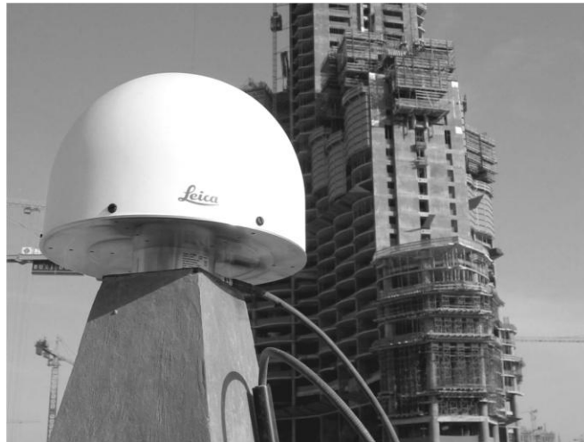
Рис. 3. Базова станція вихідної геодезичної мережі будівлі
