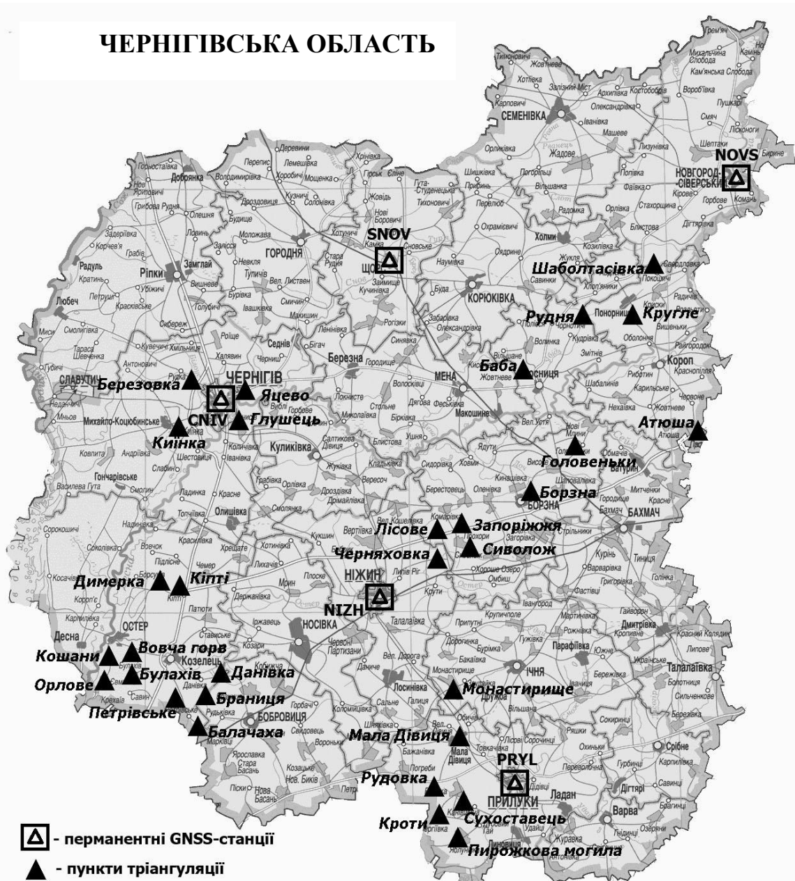
Рис. 6. Схематичне розміщення пунктів триангуляції на Чернігівщині, на яких виконували GNSS спостереження
