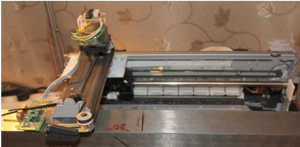
Рис. 12. Механізм для переміщення датчиків над зразком
