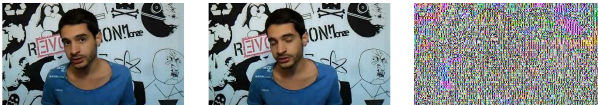
Рис. 3. Восстановление дифференцированного представления базового кадра при зашифрованном базовом с качеством 34%, \kappa = 2.1086 , PSNR = 6.0912
