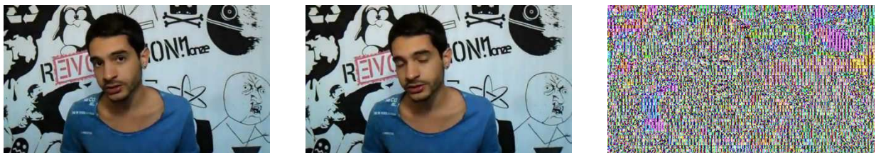
Рис. 4. Восстановление дифференцированного представления базового кадра при зашифрованном базовом с качеством 67%, \kappa = 2.0557 , PSNR = 6.1062
