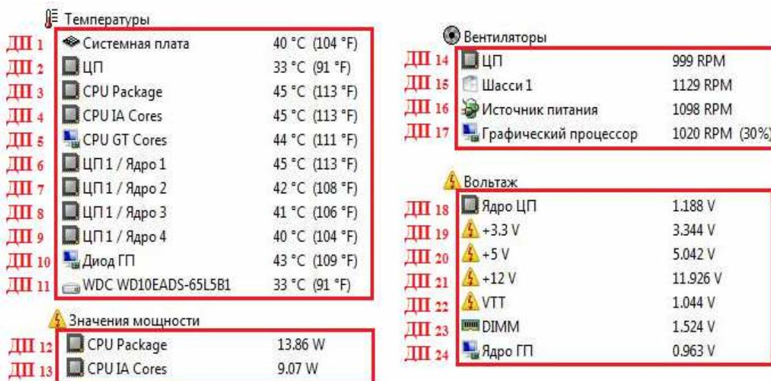
Рис. 2. Диагностические параметры персонального компьютера
