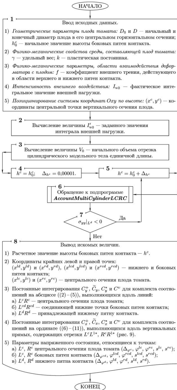
Рис. 10. Алгоритм расчета геометрии свободно-го контура и некоторых параметров напряженно-го состояния плода томата (единичного отрезка изначально цилиндрического модельного тела бесконечной длины), находящегося в окружении других таких же плодов
