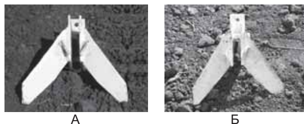
Рис. 11. Варианты СУ, у которых загортачи установлены симметрично (А) и со смещением (Б)
