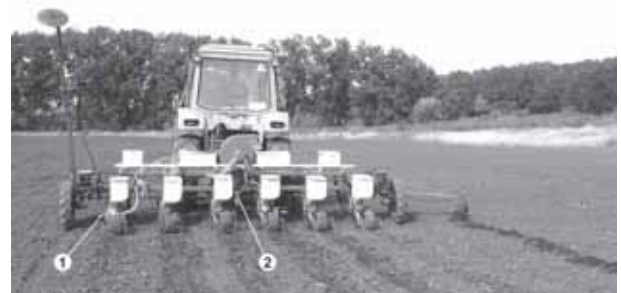
Рис. 3. Рабочее положение инерционных измерительных приборов МИС на посевной секции (1) и раме (2) сеялки
