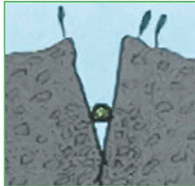
V-подібна борозна (тип сошника – двійний диск)
