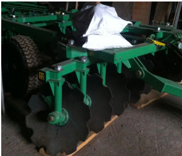
Рис. 3. Регулювання глибини дискування за допомогою додаткового вантажу на агрегаті УДА-3,1
