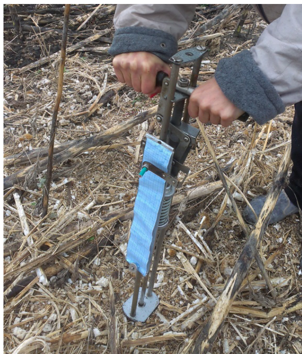
Рис. 6. Визначення твердості ґрунту
