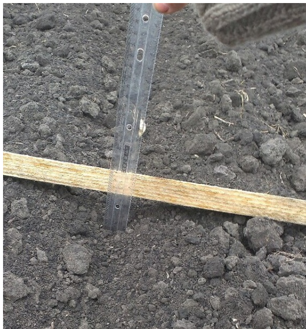
Рис. 5. Визначення гребенистості поверхні ґрунту після дискування
