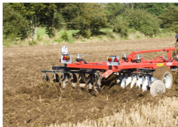
Рис. 1. Робочий процес дискування ґрунту бороною Quivogne APXTL
