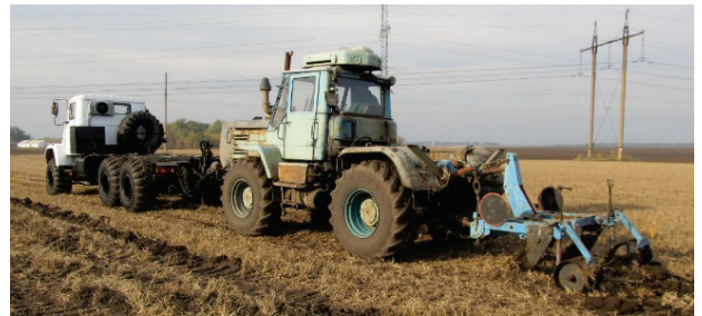
Рис. 2. Тягові випробування МЕЗ-330 «Автотрактор»
