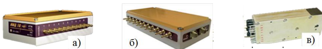
Рис. 3. Мобільні багатоканальні вимірювачі тиску
