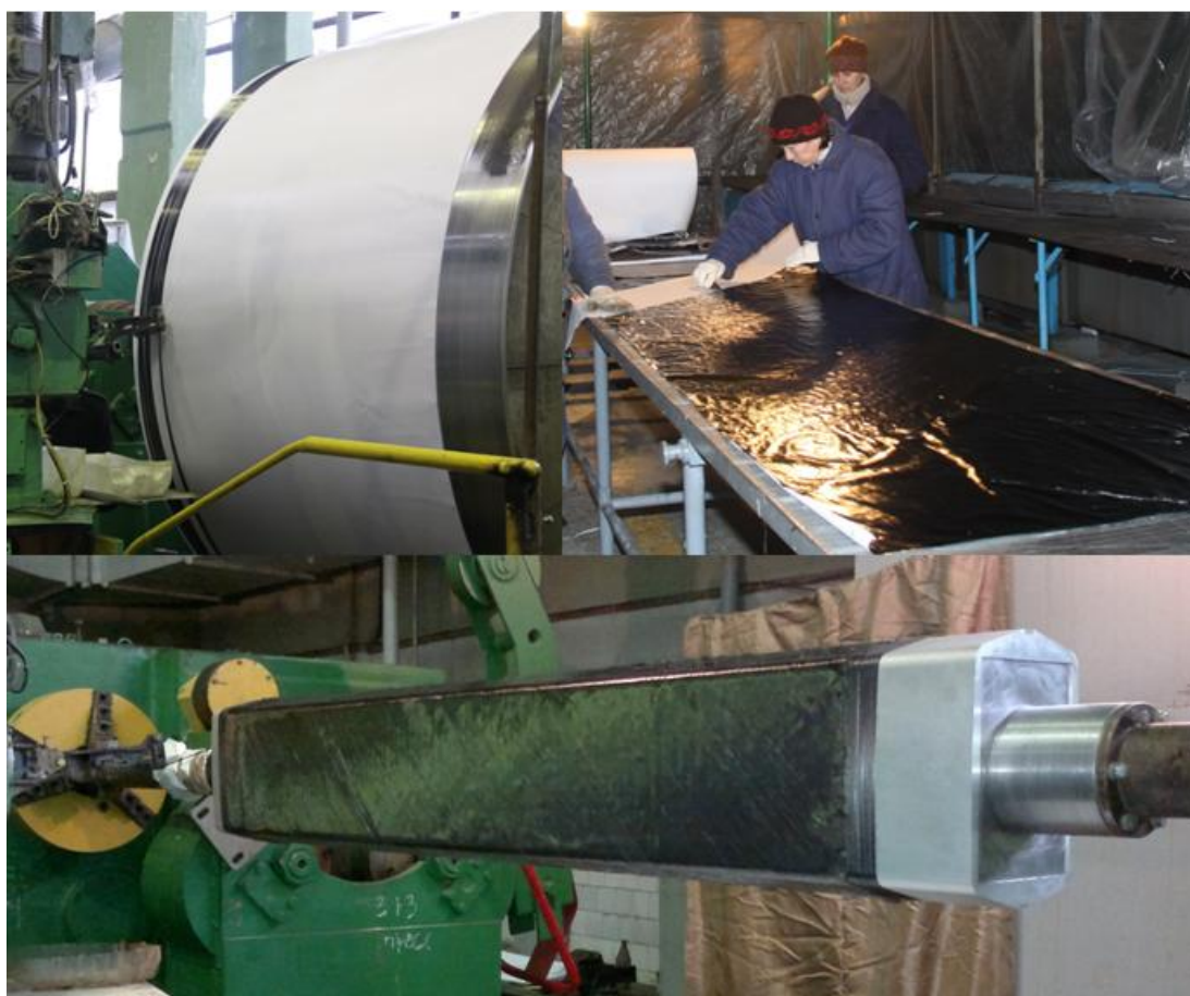
Рис. 2. Этапы изготовления желобов
